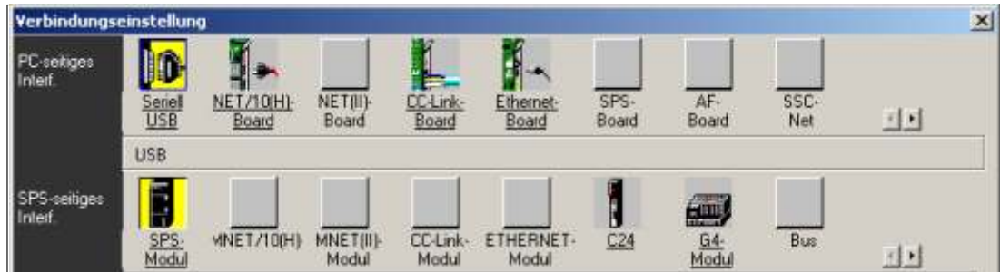
Abb. 6-19: Der PC ist in diesem Beispiel über die USB-Schnittstelle mit der CPU verbunden
