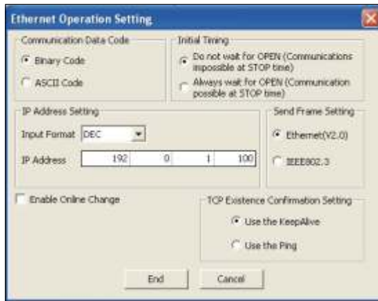
Abb. 13-23: Betriebseinstellungen in SPS 1 für dieses Beispiel
